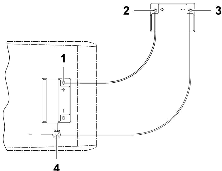
При выполнении запуска двигателя от внешнего источника с использованием внешней батареи придерживайтесь следующей последовательности подключения:
