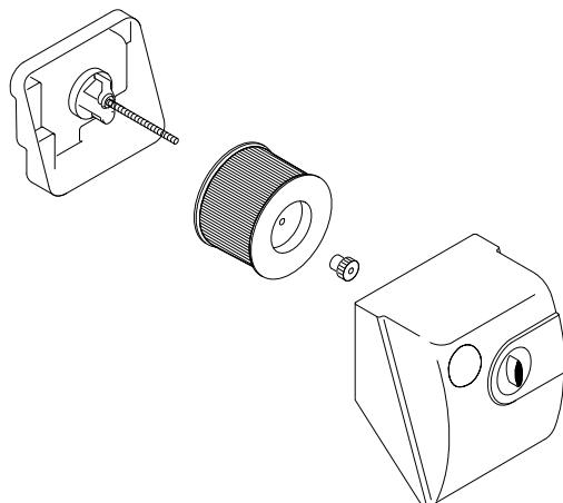
**Hinweis:** Если двигатель начинает дымить и одновременно падает мощность двигателя, это указывает на засорение фильтра.
