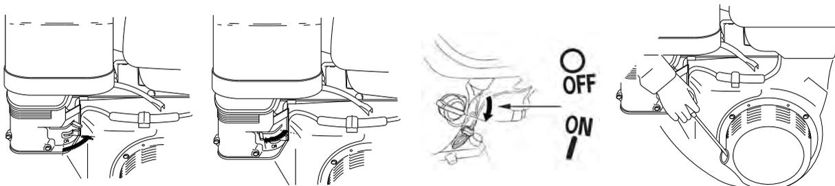
1. Поверните топливную заглушку в положение ON.
