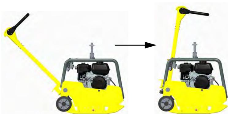
При погрузке и транспортировке направляющая рукоятка должна фиксироваться в горизонтальном положении путем защелкивания фиксатора направляющей рукоятки.
