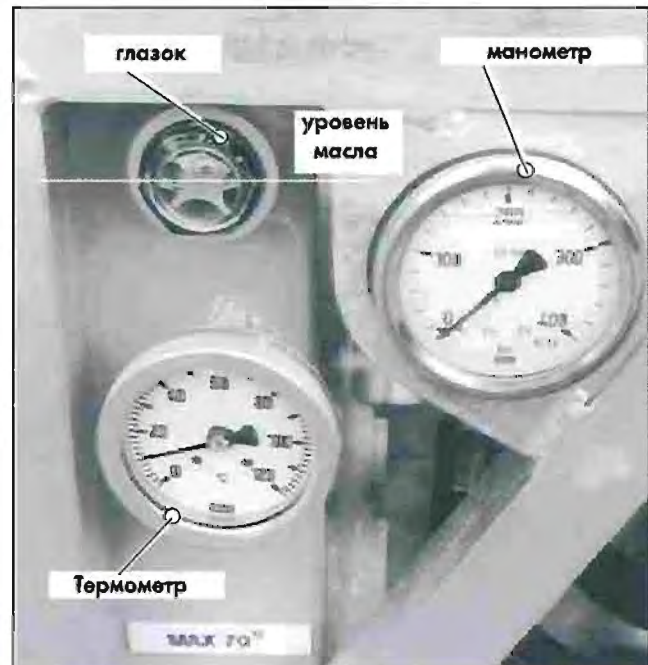
Рис. 4.1 Элементы контроля гидравлического масла, слева на HAG•12.10
