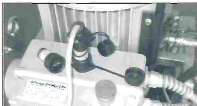
Рис. 4.10 Кабель управления зафиксирован в розетке с помощью накидной гайки (заглушка снята)
