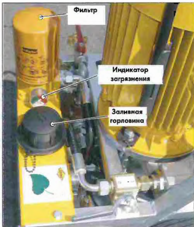
Рис. 4.2 Заливная горловина с сеткой-фильтром, фильтр с указателем загрязнения, спереди на HAG•12.10
