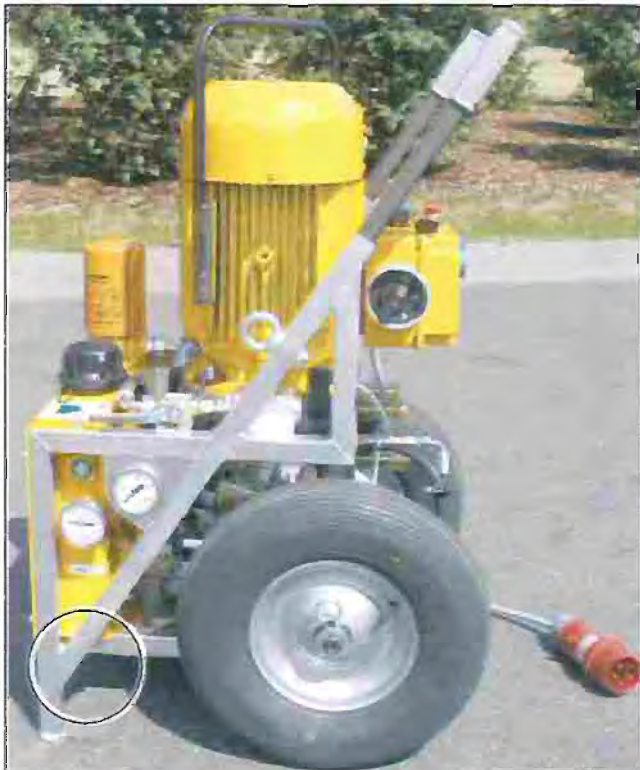
Рис. 6.1 Место сливной пробки на HAG-12.10
