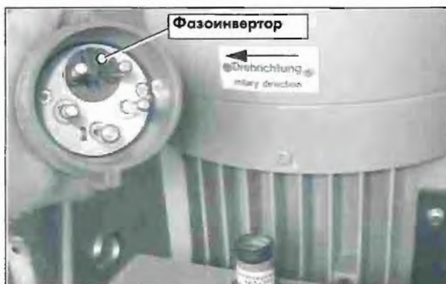
Рис. 5.1 СЕЕ-штекер с фазиинвертором и стрелка направления вращения двигателя на HAG•12.10 (над корпусом главного выключателя)
