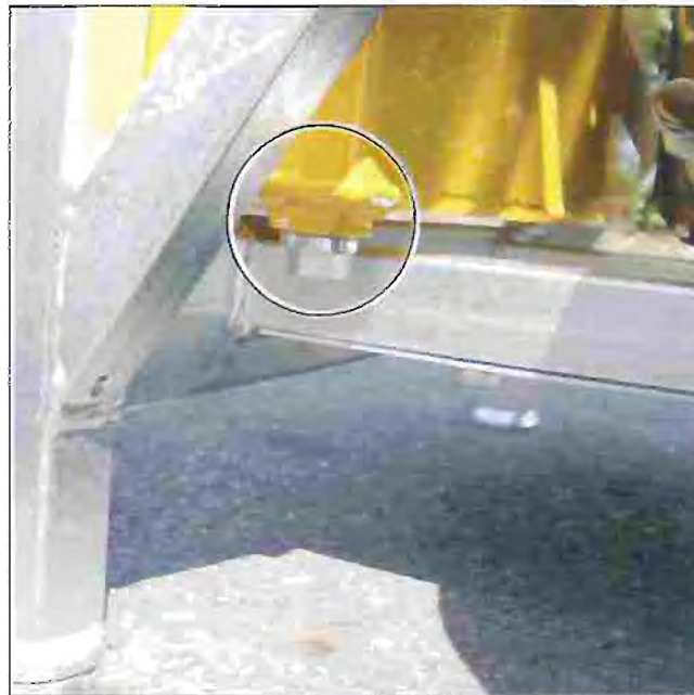
Рис. 6.2 Сливная пробка на баке HAG-12.10
