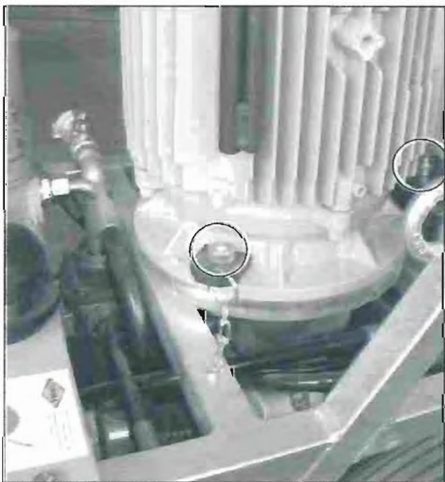
Рис. 7.2 Место двух крепежных гаек и вставных шайб электромотора
