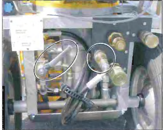
Рис. 4.7 HAG•12.10 сзади, рычаг клапана установлен на производительность от 30 л/мин на 44 л/мин, шланг контура управления подключен напрямую
